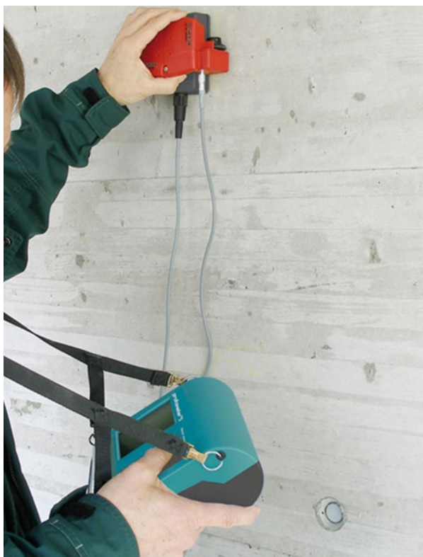
Figur 7.4 Måling av armeringsoverdekning. (Foto: Proceq)
