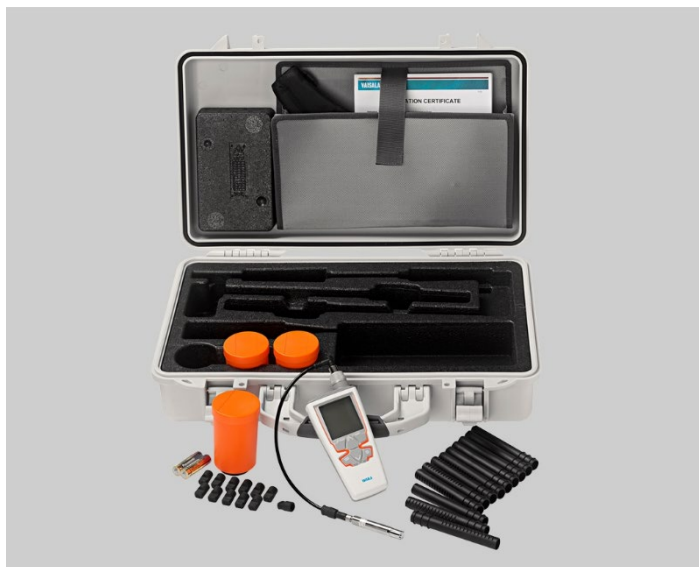
Figur 7.32 Utstyr for måling av relativ fuktighet. (Foto: Multiconsult AS)
