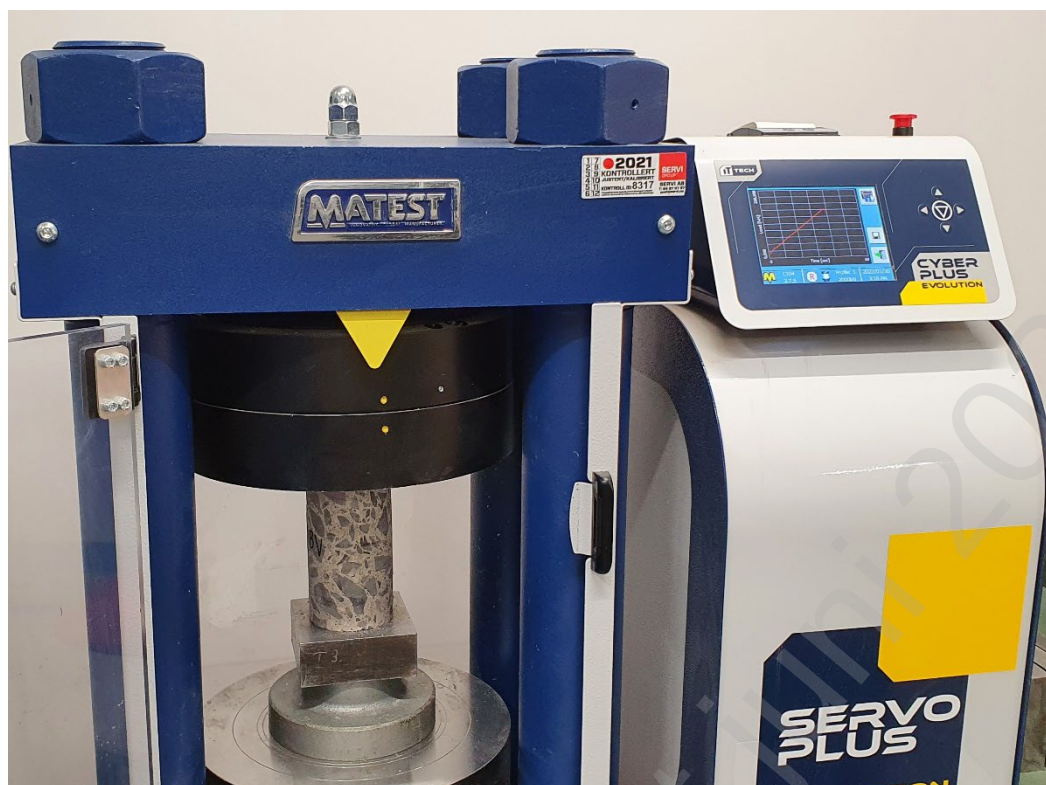
Figur 8.1 Måling av trykkfasthet. (Foto: Multiconsult AS)
