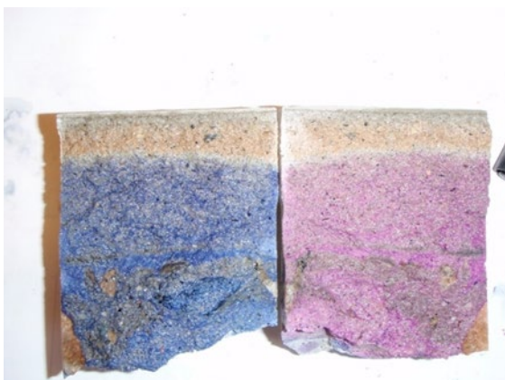
Figur 7.6 Fargeomslag ved bruk av tymolftalein og fenolftalein. (Foto: Stærk & Co as)
