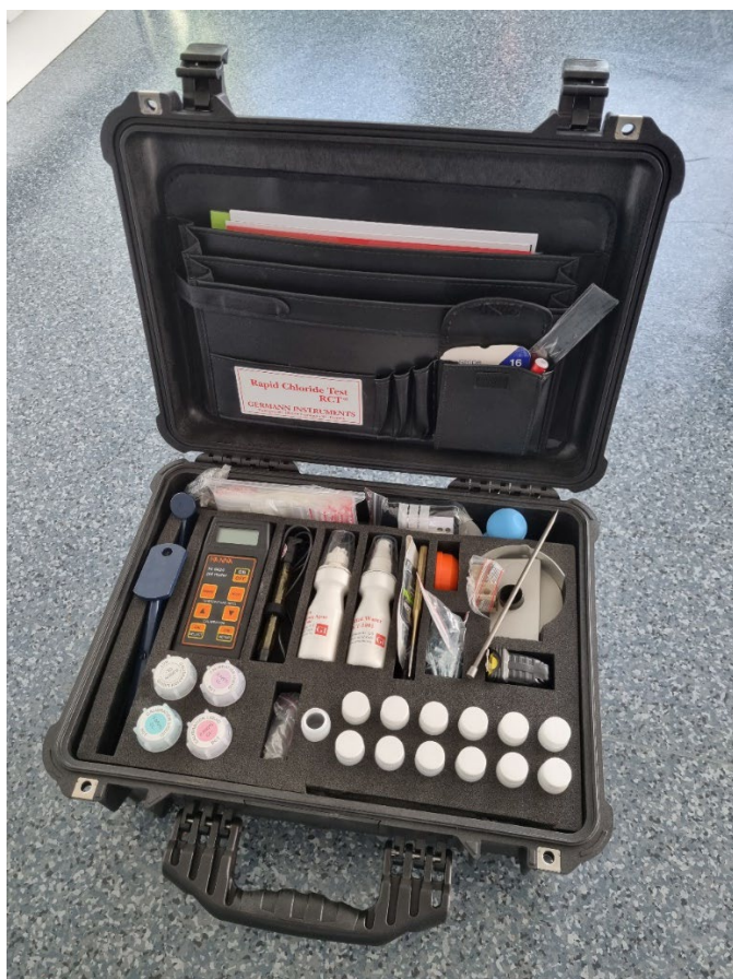
Figur 7.9 RCT-utstyr. (Foto: Stærk & Co as)
