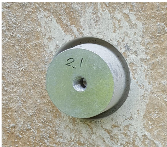
Figur 7.25 Saging av spor rundt prøvekoppen før avtrekk. (Foto: Stærk & Co as)
