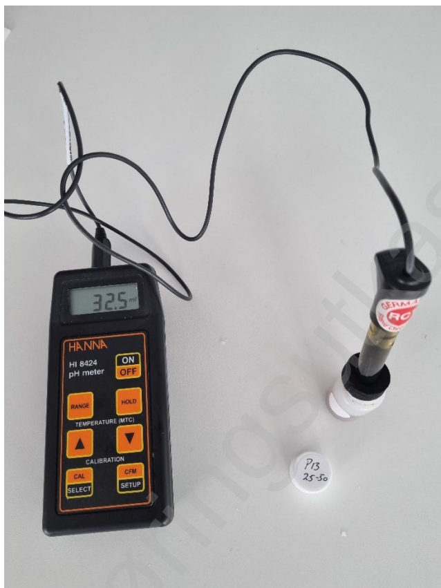
Figur 7.14 Måling av kloridinnhold. (Foto: Stærk & Co as)
