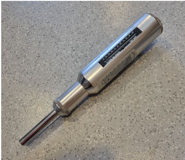
Figur 7.27 Analog prellhammer. (Foto: Stærk & Co as)
