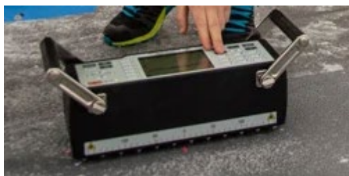
Figur 7.30 Utstyr for ultralydmålinger. (Foto: KIWA as)
