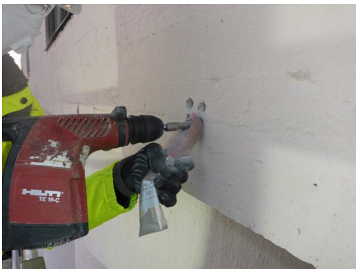
Figur 7.10 Uttak av borstøv for kloridanalyse. (Foto: Multiconsult AS)
