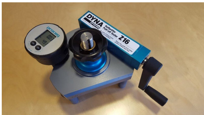
Figur 7.23 Utstyr for måling av heftfasthet. (Foto: Stærk & Co as)
