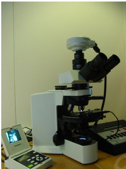
Figur 8.10 Polarisasjonsmikroskop for analyse av tynnslip. (Foto: Norconsult AS)
