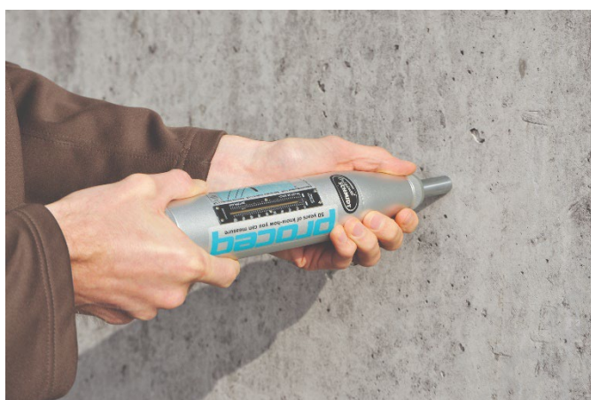
Figur 7.29 Utførelse målinger med prellhammer. (Foto: Stærk & Co as)
