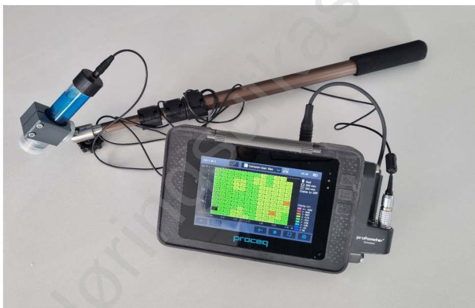
Figur 7.20 Utstyr for EKP-målinger med kobber/kobbersulfat elektrode. (Foto: Stærk & Co as)
