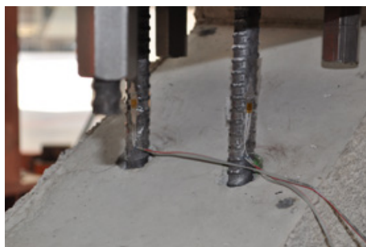
Figur I-2: Strekkklapper montert på vanlig armering (venstre) og Stag Dywidag (høyre).
